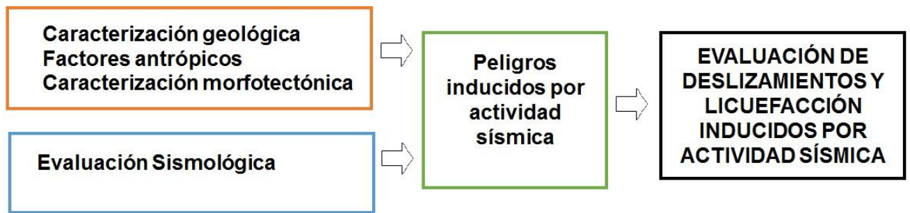
Figura 15. Flujograma general de la aplicación de métodos integrados para la evaluación de deslizamientos y licuefacción de suelos, inducidos por la actividad sísmica. Fuente: Autora.
